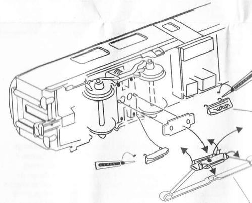
Magnet-Schienenbremse nur auf Drehgestell 2, beidseitig.
