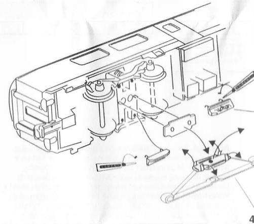
Magnet-Schienenbremse nur auf Drehgestell 2, beidseitig.
