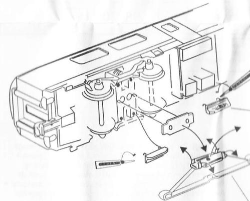
Magnet-Schienenbremse nur auf Drehgestell 2, beidseitig.
