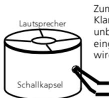
Zum Erreichen eines optimalen Klangs sollte der Lautsprecher unbedingt in eine Schallkapsel eingebaut werden. Dadurch wird der Schalldruck erhöht und in der Richtung kanalisiert. Ohne Einsatz einer entsprechenden Schallbox wird der Klang möglicherweise nicht Ihren Ansprüchen genügen.
