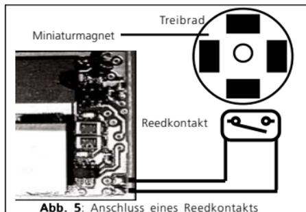
Abb. 5: Anschluss eines Reedkontakts
