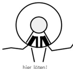
Bitte behandeln Sie die Lautsprecher mit äußerster Vorsicht: Üben Sie keinen Druck auf diese aus und berühren Sie die Membrane nicht! Die Magnete der Lautsprecher sind sehr stark! Halten Sie alle metallischen Gegenstände von den Lautsprechern fern und fixieren Sie die Lautsprecher beim Anlöten der Kabel, weil sonst u. U. der Lautsprecher vom Lötkolben angezogen wird und zerstört werden kann.
