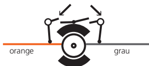
Abbildung 10: 5-poliger Märklin® Hochleistungsmotor
