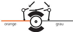
Abbildung 9: 5-poliger Märklin® Hochleistungsmotor
