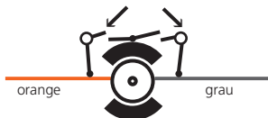
Abbildung 9: 5-poliger Märklin® Hochleistungsmotor
