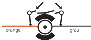
Abbildung 9: 5-poliger Märklin® Hochleistungsmotor
