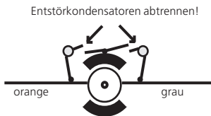
Abbildung 9: 5-poliger Märklin® Hochleistungsmotor
